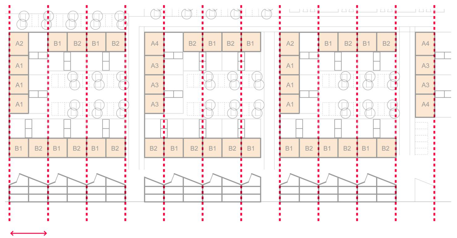
15m betonconstructie in het zicht op basis van stramien fabriekshallen
