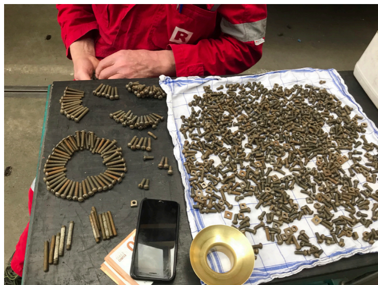
De originele schroeven worden schoongemaakt
