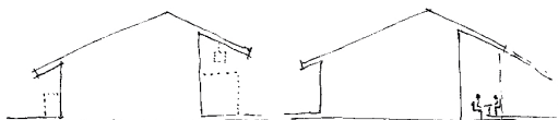
Onder overstekken droge buitenplekken voor mensen en dieren (veranda's geven zowel architectonisch als klimatologisch beschutting)
